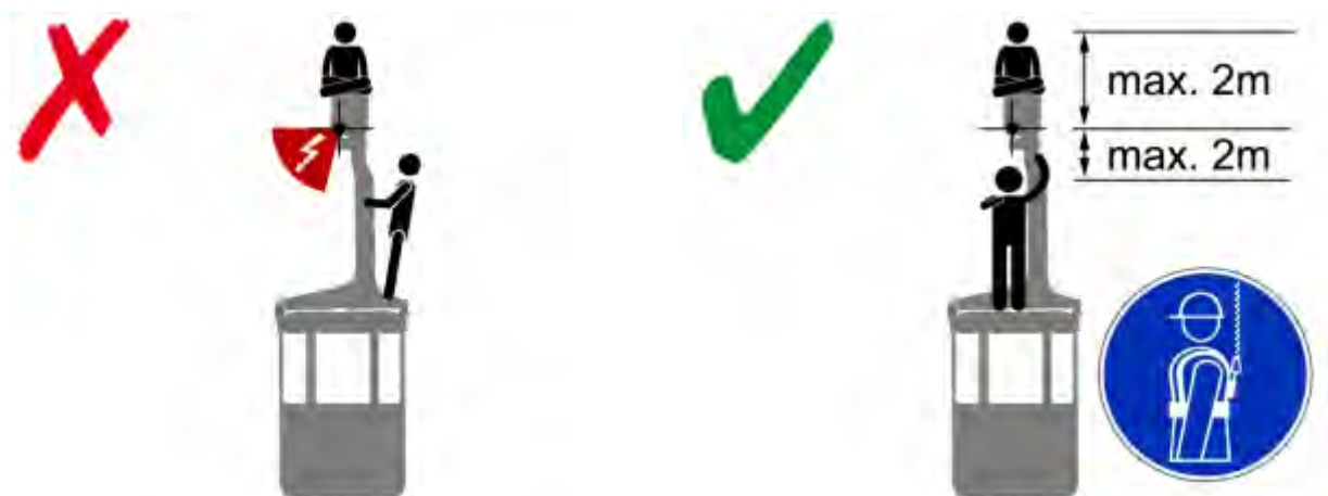
Photo 6.11 : Mauvais positionnement lors de l'examen du câble porteur. Un angle du câble d'env. 45 ° n'est pas visible
