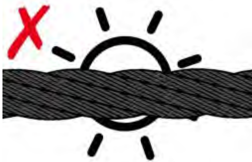
Illustration 1 : Soleil éblouissant en arrière-plan, pas de contraste convenable par rapport au câble
