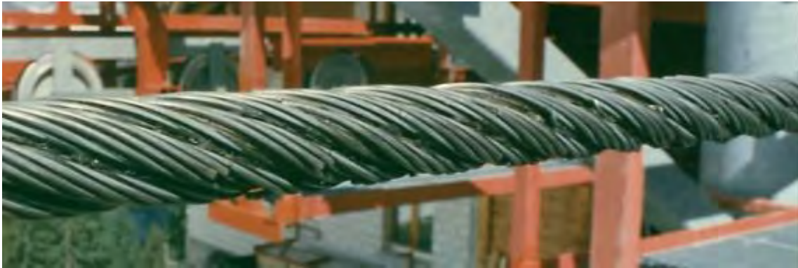
Photo 2.1 : Dommages causés par glissement d'une plaque de serrage
