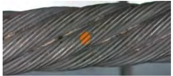
Photo 4.24: Corrosion 0,5 x diamètre du toron
