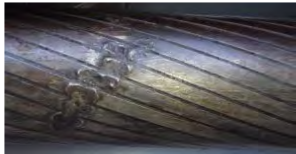
Photo 2.15 : Point de sortie sur le câble
