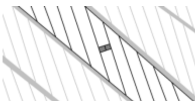
Illustration 4.10 : Rupture de fil simple reconstituée graphiquement
