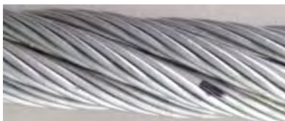
Photo 4.13 : Rupture de fil simple dans une gorge de toron
