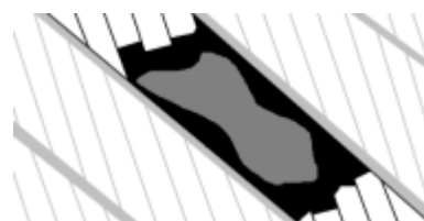
Illustration 4.12 : Rupture d'un toron entier reconstituée graphiquement
