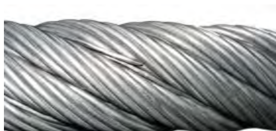
Illustration 4.9 : Rupture avec fil qui dépasse
