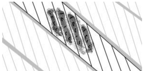
Illustration 4.20 : Corrosion sur plusieurs torons reconstituée graphiquement
