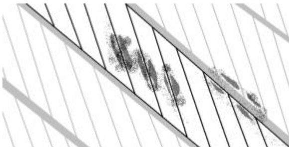
Illustration 4.19 : Corrosion dans une gorge de toron reconstituée graphiquement
