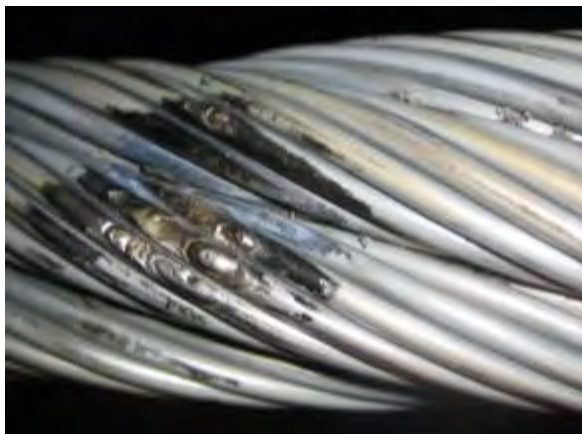
Photo 2.10 : Défaut causé par la foudre sur un câble à torons
