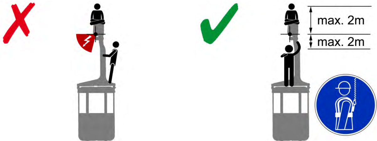
Illustration 11: Mauvaise position lors de l'inspection des câbles de chenilles. Environ 45° de la corde ne sont pas visibles
