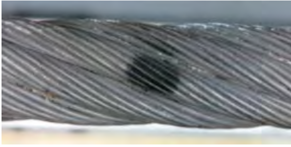
Photo 4.15 : Rupture de fils métalliques 1 x diamètre du toron
