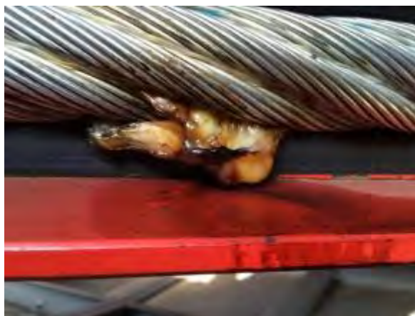
Photo 2.7 : Dommage causé par la circulation du courant
