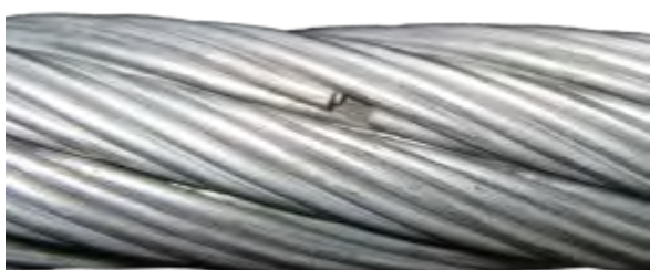
Illustration 4.8 : Rupture de fil simple
