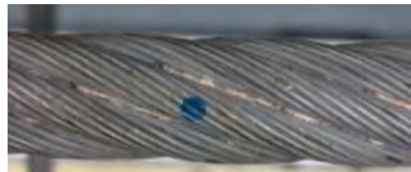
Photo 4.7 : Impact de foudre 0,5 x diamètre du toron
