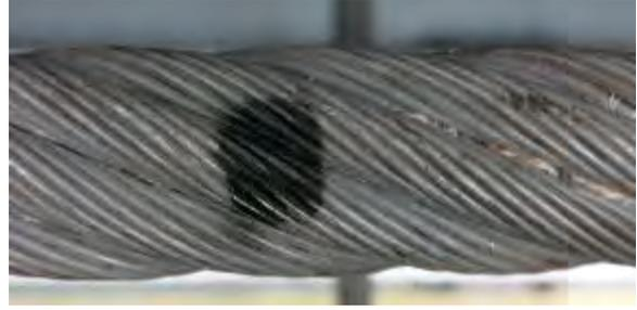
Figura 4-16: Rotura de alambre, 1.5 x diámetro del cordón
