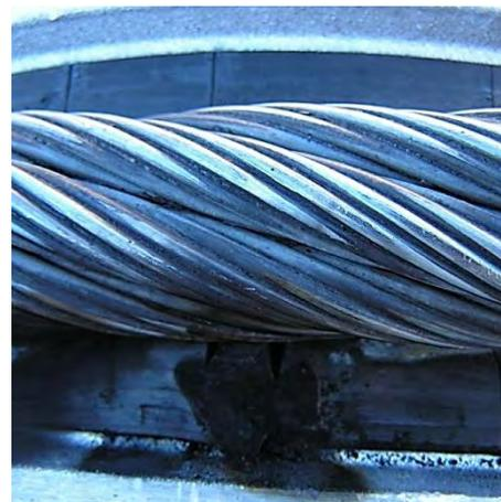
*Figura 2-5: Daño por circulación de corriente*
