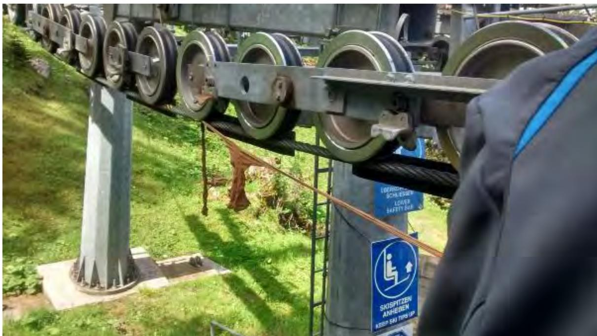
*Figura 5-19: Media enganchada en el cable y arrastrada hacia rodillos de balancín*
