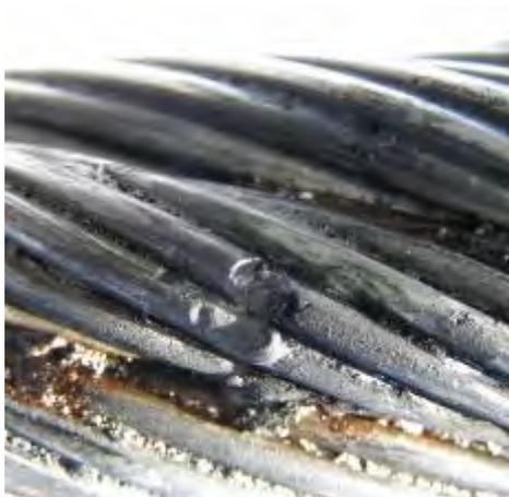
*Figura 2-4: Daño por circulación de corriente*
