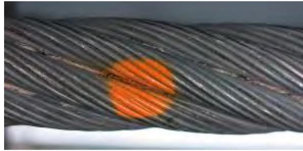
*Figura 4-22: Corrosión, 1.5 x diámetro de cordón*
