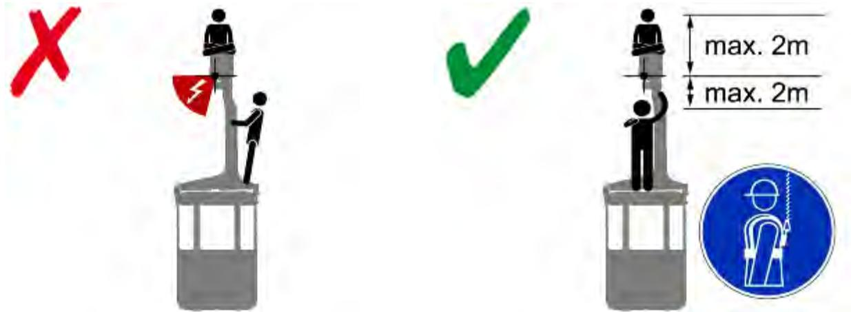
Figura 6-11: Mal posicionamiento para inspección en cable carril. Cerca de 45° de la sección del cable no se visualiza.
