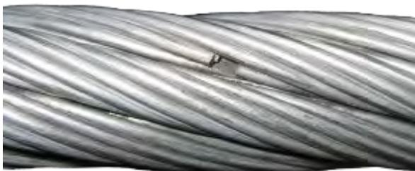
Figura 4-8: Rotura de un alambre
