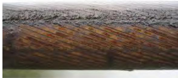
Figura 4-18: Corrosión en cable cerrado
