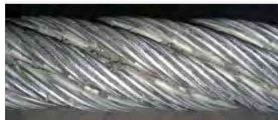
*Figura 4-26: Aplastamientos en cable tractor*
