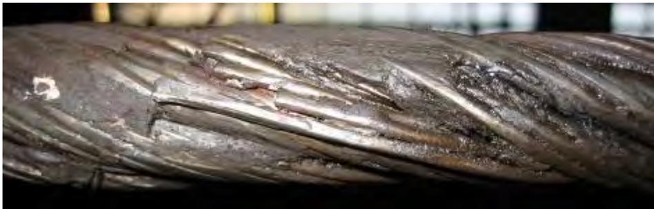
*Figura 6-13: Cable sucio - no es posible realizar la inspección*
