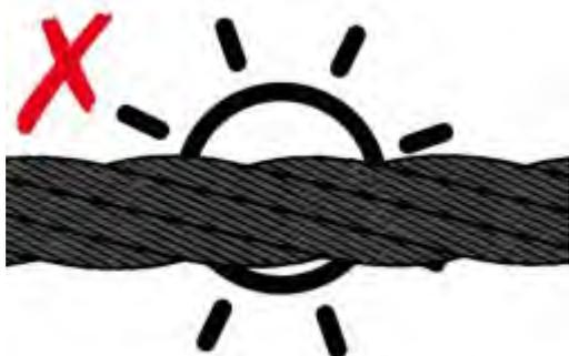
Imagen 1: Sol deslumbrante de fondo - Mal contraste con el cable
