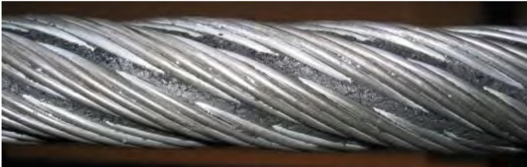
Imagen 13: Suciedad entre cordones – Difícil de inspeccionar
