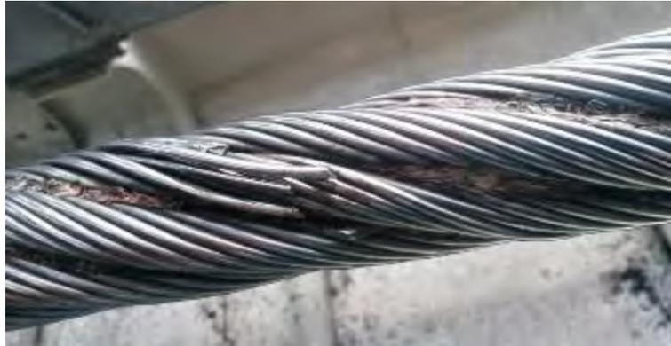
*Figura 2-3: Deformación en entrada de empalme, con múltiples roturas de alambres*
