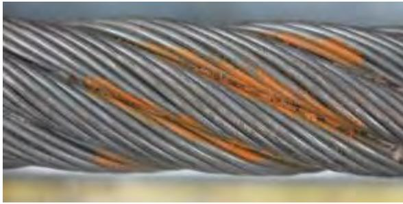
*Figura 4-21: Corrosión entre cordones*
