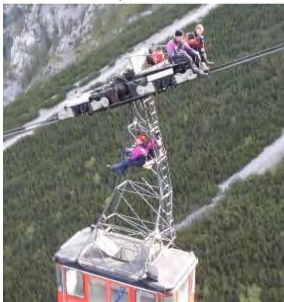
*Figura 3-10: Inspección visual en cable carril, utilizando una plataforma especial para sentarse o recostarse*
