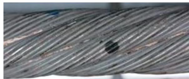
Figura 4-14: Rotura de alambre, 0.5 x diámetro del cordón
