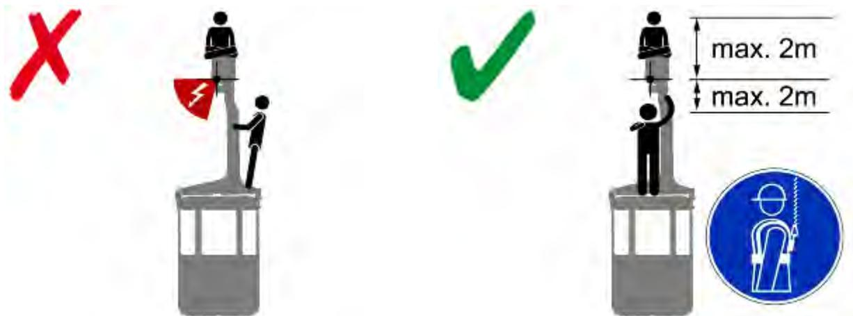
Imagen 10: Mal posicionamiento para inspección en cable carril. Cerca de 45° de la sección del cable no se visualizan.
