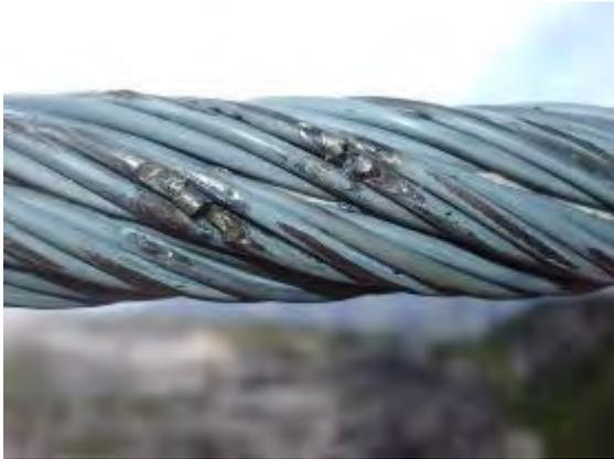
*Figura 4-2: Martensita en alambres fundidos*
