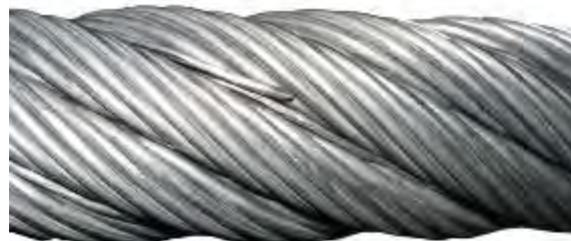
Figura 4-9: Rotura con un alambre sobresaliente
