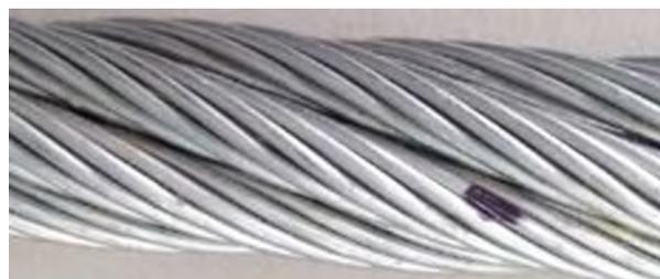
Figura 4-13: Rotura de alambre en zona de contacto entre cordones
