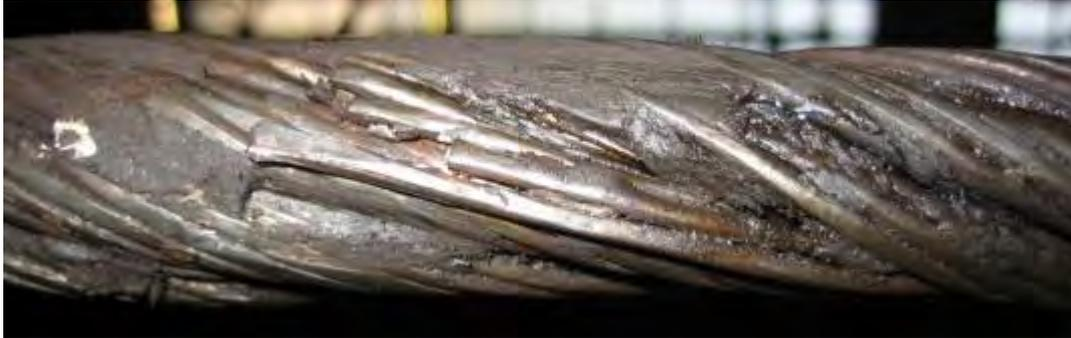
Imagen 12: Cable muy sucio - ¡No es posible realizar la inspección!
