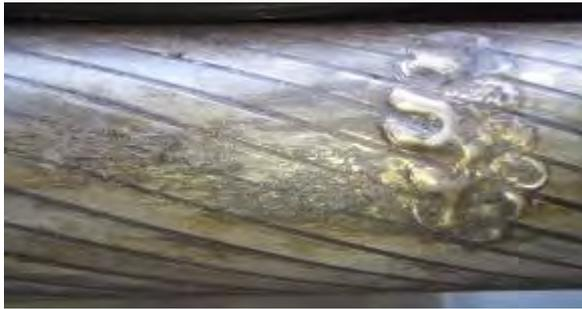
*Figura 2-14: Punto de impacto en la cara inferior del cable*
