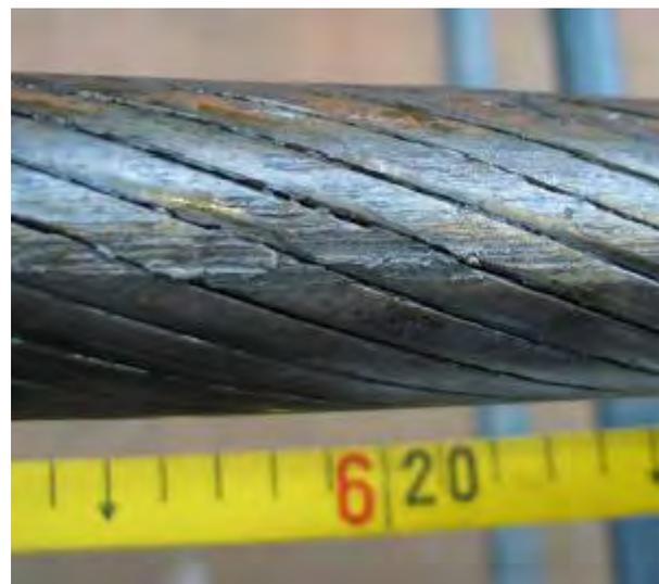
Figura 2-9: Cable portante dañado - Detalle [6]
