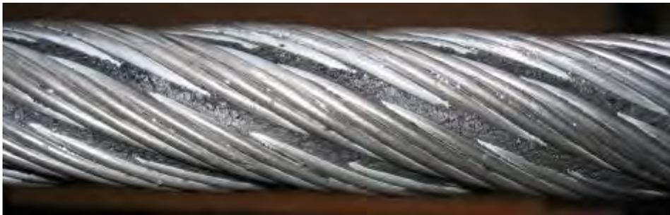
*Figura 6-14: Suciedad entre cordones - difícil de inspeccionar*
