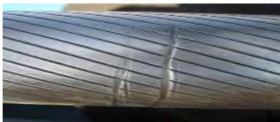
*Figura 4-25: Melladuras en cable portante*
