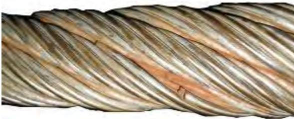
Figura 4-17: Corrosión en zona de contacto entre cordones (con cortes)
