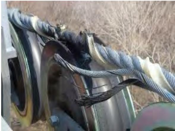
Figura 2-6: Daño por circulación de corriente
