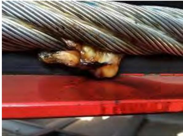
Figura 2-7: Daño por circulación de corriente
