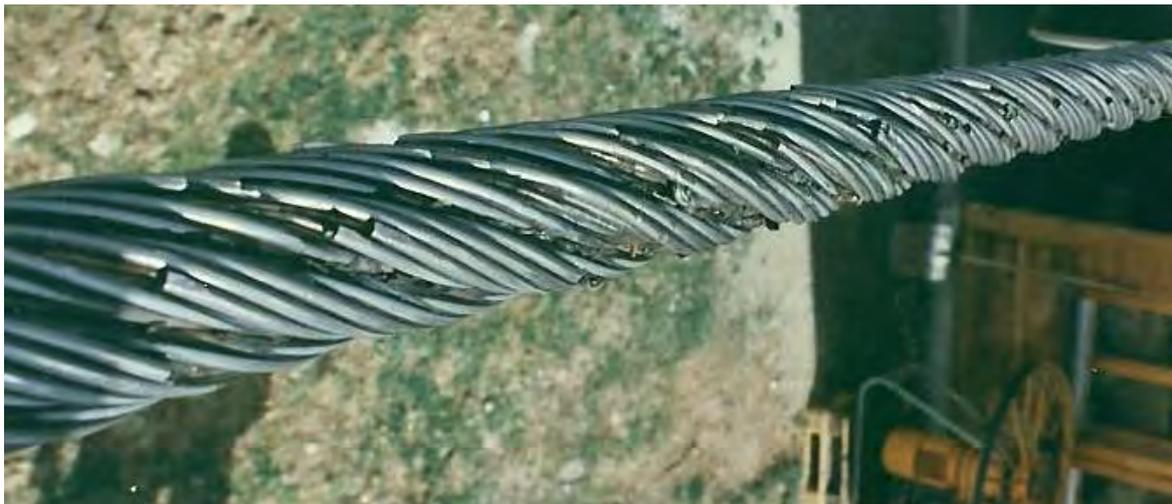
*Figura 2-2: Daños por deslizamiento de mordaza*
