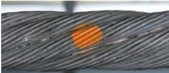
*Figura 4-23: Corrosión, 1.0 x diámetro de cordón*
