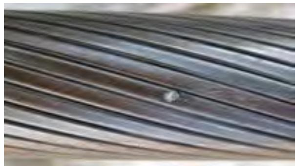
Figura 2-13: Descarga atmosférica en cable cerrado
