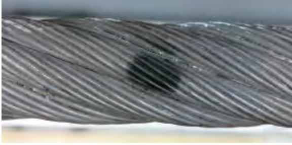
Figura 4-15: Rotura de alambre 1.0 x diámetro del cordón
