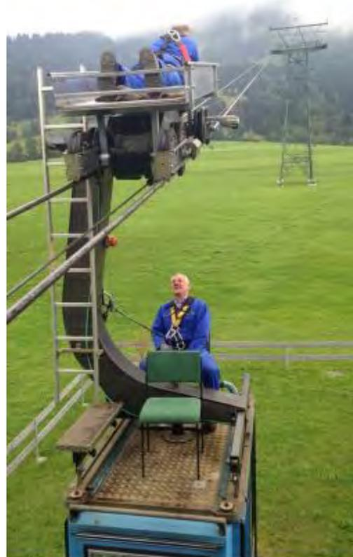
*Figura 5-28: Silla utilizada sobre una cabina durante una inspección visual*
