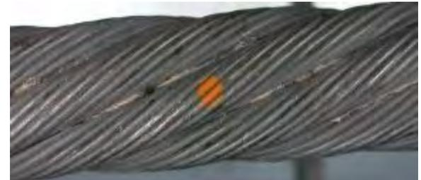
*Figura 4-24: Corrosión 0.5 x diámetro de cordón*
