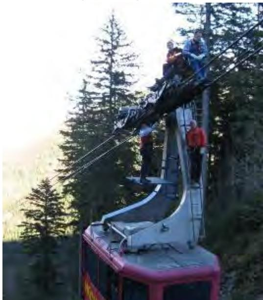
*Figura 3-8: Inspección visual en cable carril, utilizando escalera, plataforma, silla y el carro portador*
