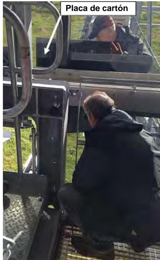
*Figura 5-24: Utilización de placa de cartón como protección solar*
