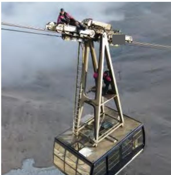
*Figura 3-9: Inspección visual en cable carril, utilizando plataforma especial y carro portador*
