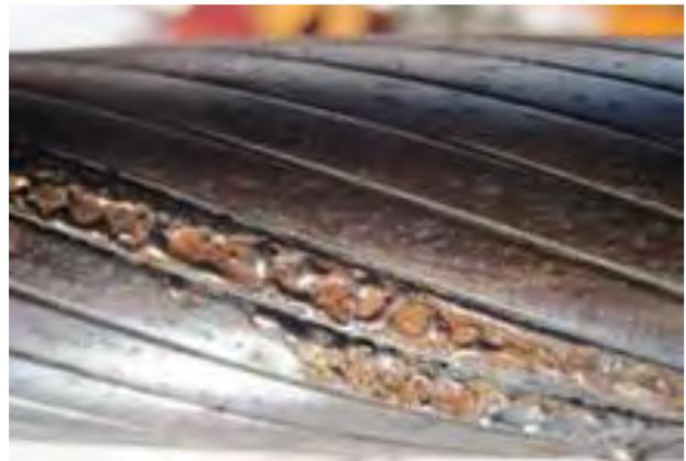
Figura 2-11: Descarga atmosférica en cable cerrado
