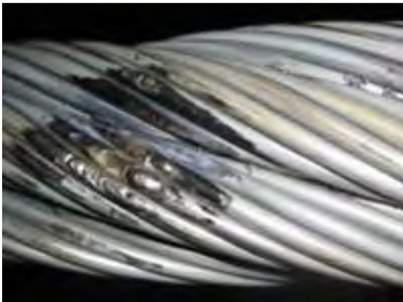
Figura 2-10: Descarga atmosférica en cable a cordones
