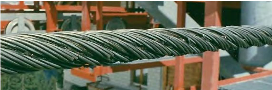
*Figura 2-1: Daños por deslizamiento de mordaza*
