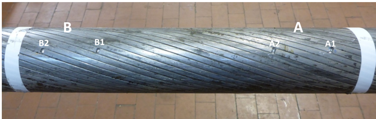
Figura 13: fune realizzata presso Laboratorio 2, difetti esterni
