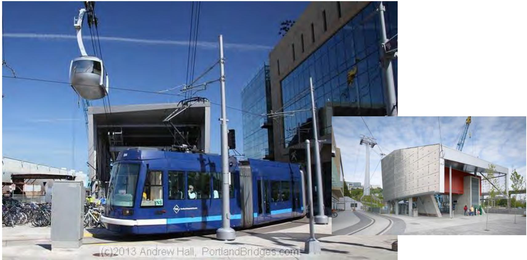
Vor allem Umlaufseilbahnen sind **hochanschlussfähig** zu anderen Verkehrsmitteln, weil sie als Stetigförderer immer bereit stehen. Die hohe Frequenz sichert Leistungsfähigkeit auch bei kleinen Kabinen
