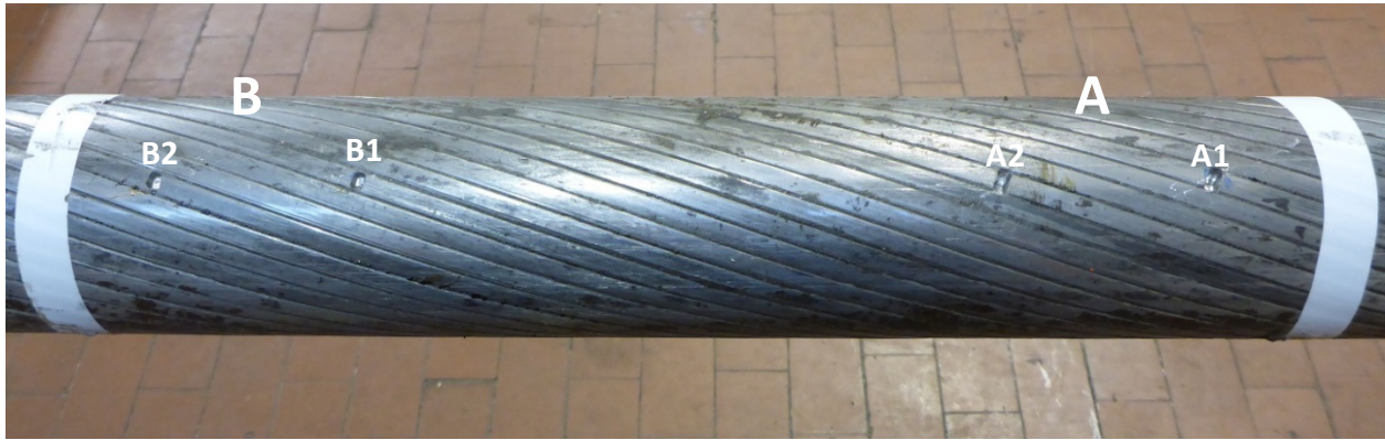
Figura 13: fune realizzata presso Laboratorio 2, difetti esterni
