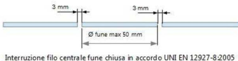
Figura 12: difetto standard secondo UNI 12927-8
