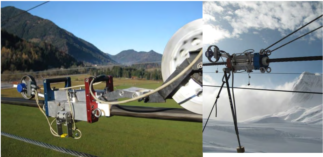
Abbildung 22: Montage des MRT-Geräts bei einem stehenden (links) und einem laufenden Seil (rechts).
