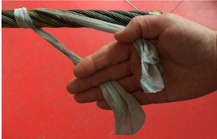
Abbildung 5.20: Sicheres Halten eines Nylonstumpfes
