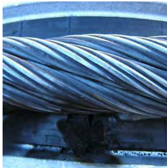
Abbildung 2.5: Schaden durch Stromfluss
