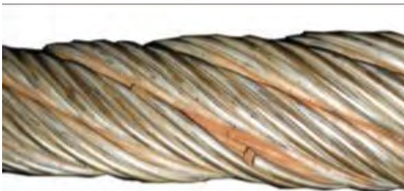
Abbildung 4.17: Litzengassenkorrosion (mit Drahtbrüchen)
