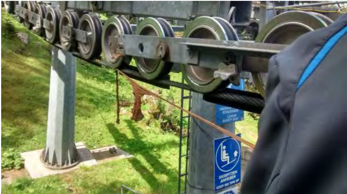
Abbildung 5.19: Strumpf, der am Seil hängen bleibt und unter die Rollen geraten ist
