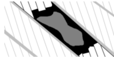
Abbildung 4.12: Bruch komplette Litze abstrahiert
