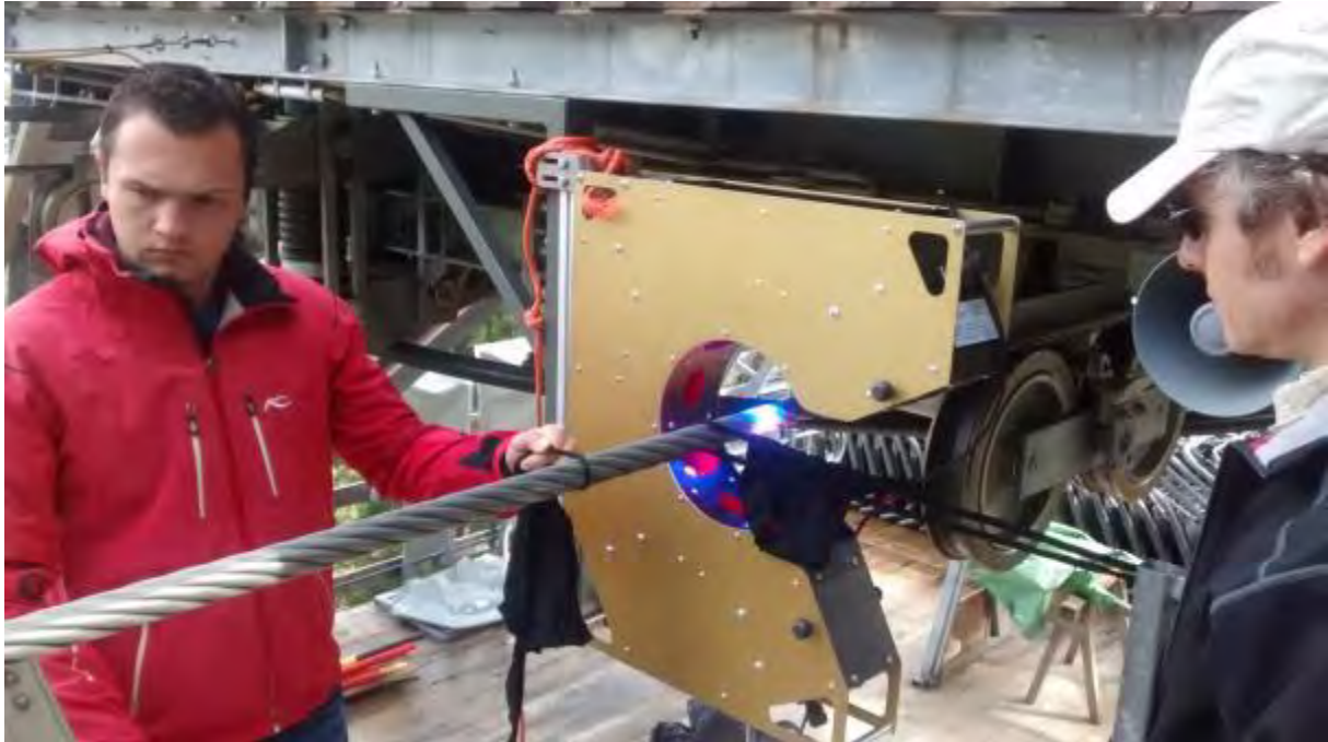
Abbildung 5.18: Inspektion mit Nylonstrumpf
