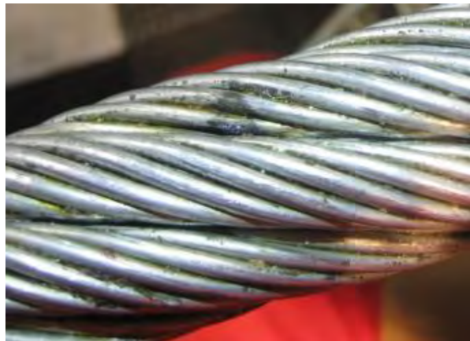
Abbildung 4.1: Blitzschlag bläulich verfärbt
