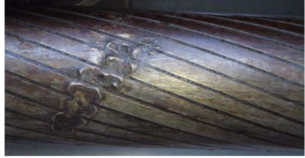
Abbildung 2.15: Einschlag-/Austrittsstelle an der Seite des Seils
