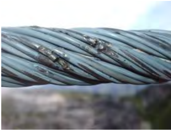
Abbildung 4.2: Martensitstrukturen mit geschmolzenen Drähten
