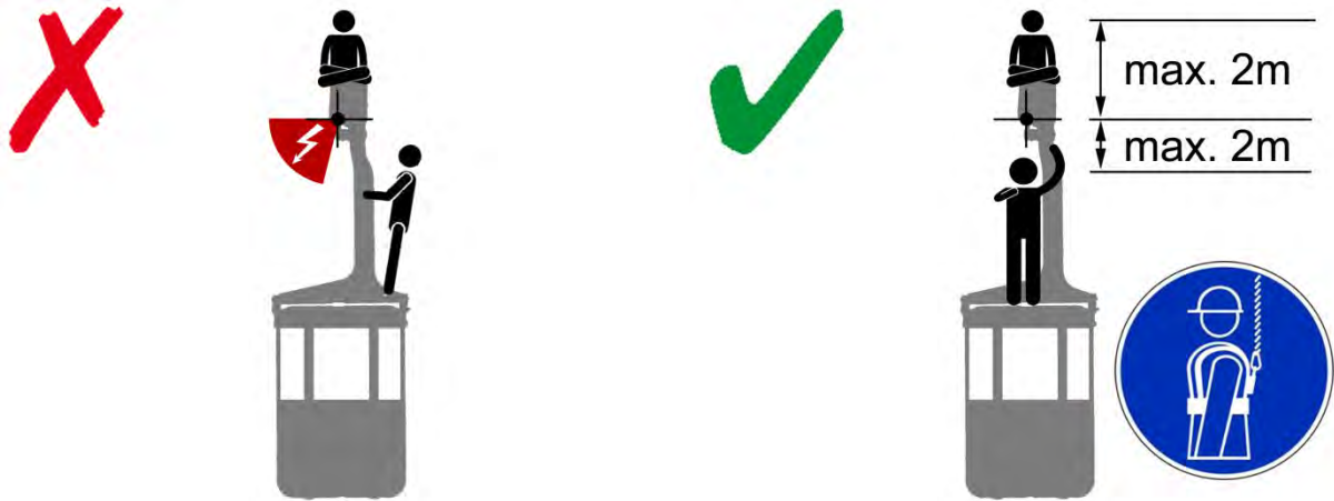
Picture 11: Schlechte Arbeitsposition während Tragseilprüfung, ca. 45 ° vom Seil können nicht eingesehen werden
