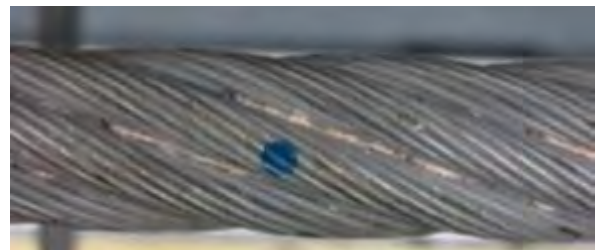
Abbildung 4.7: Blitzschlag 0,5 x Litzendurchmesser
