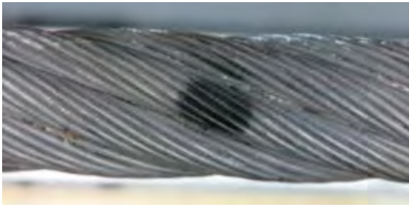
Abbildung 4.15: Drahtbruch 1 x Litzen- durchmesser
