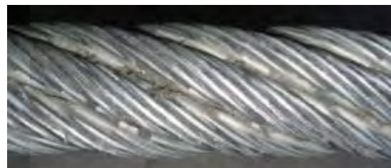
Abbildung 4.26: Riefen auf einem Zugseil
