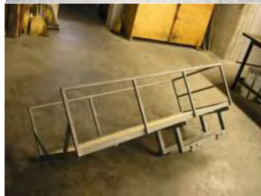
Abbildung 3.5: Vorrichtungen zur visuellen Seilinspektion
