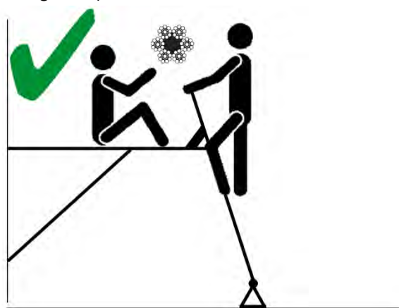
Abbildung 6.10: Empfohlene Verwendung einer Leiter
