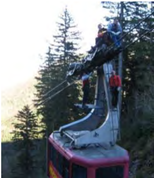
Abbildung 3.8: Visuelle Inspektion von Tragseilen auf der Leiter, einer Plattform, einem Sitz und dem Laufwerk
