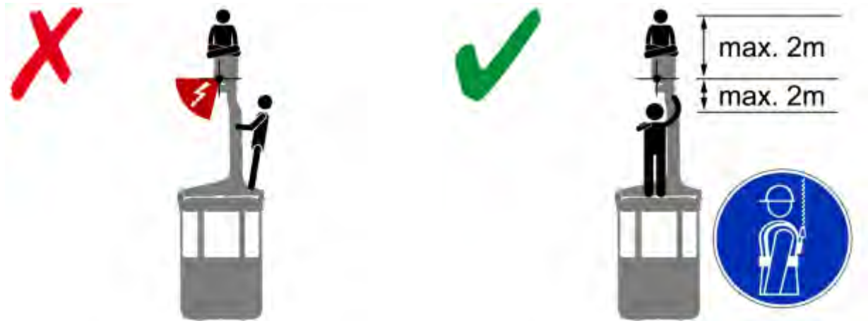
Abbildung 6.11: Schlechte Positionierung bei der Tragseilinspektion. Ca. 45 ° des Seiles sind nicht einsehbar.
