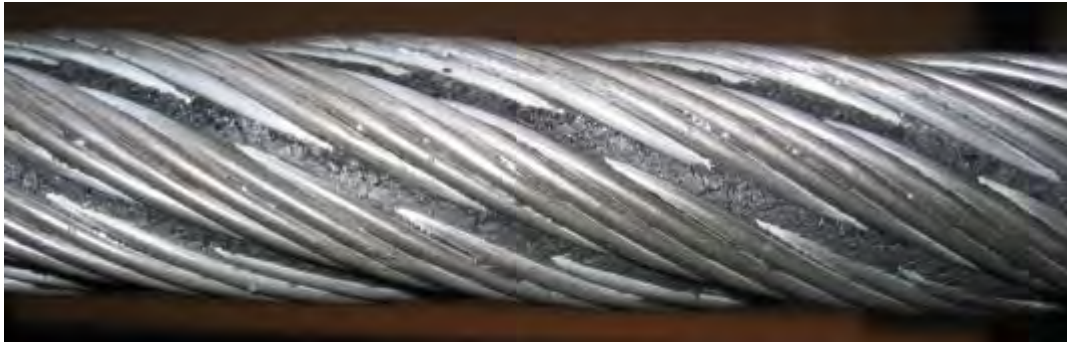
Abbildung 14: Schmutz in Litzengassen – schwer zu inspizieren
