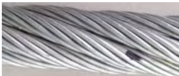
Abbildung 4.13: Einzeldrahtbruch in Litzengasse
