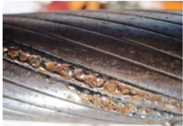
Abbildung 2.11: Blitzschaden an VVS
