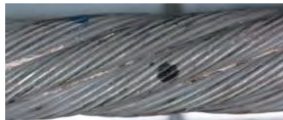
Abbildung 4.14: Drahtbruch 0,5 x Litzendurchmesser
