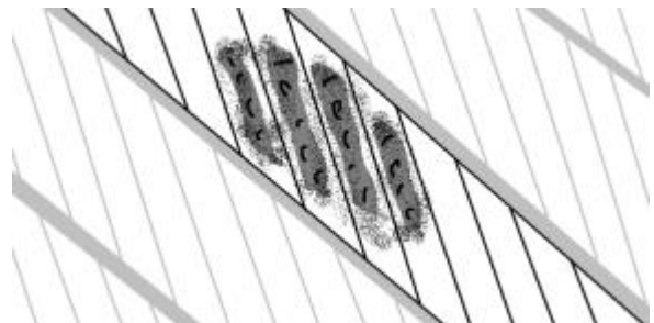
Abbildung 4.20: Korrosion über mehrere Litzen abstrahiert
