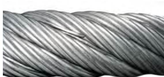
Abbildung 4.9: Drahtbruch mit abstehendem Draht
