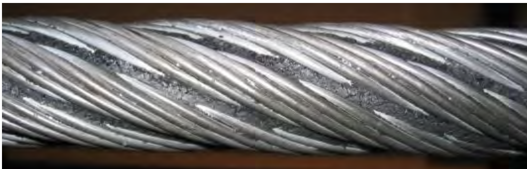
Abbildung 6.14: Schmutz in Litzengassen – schwer zu inspizieren
