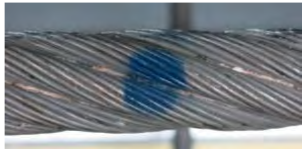
Abbildung 4.5: Blitzschlag 1,5 x Litzendurchmesser
