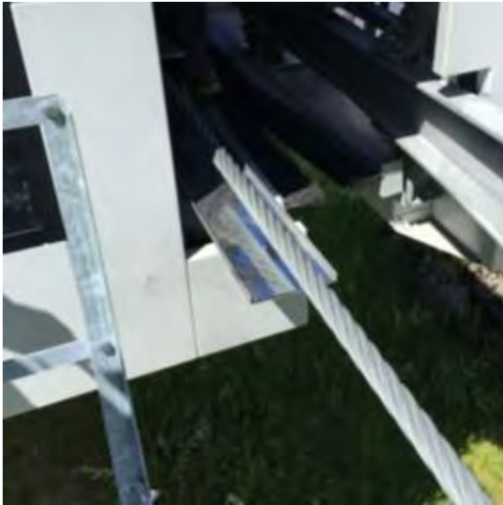
Abbildung 3.12: Spiegel an standardisierter Modulstation für Einseilumlaufbahnen (Blick von außerhalb der Station)
