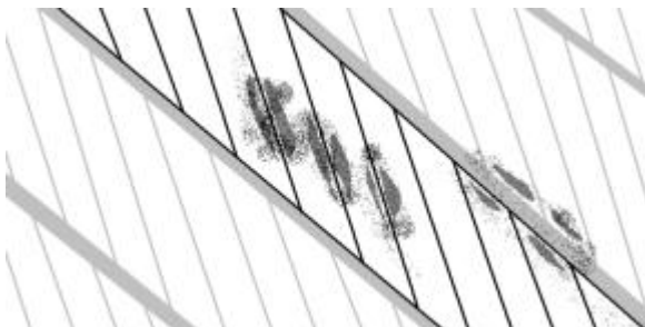
Abbildung 4.19: Korrosion in Litzengasse abstra- hiert
