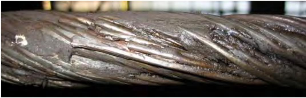
Figura 13: Lo sporco lungo la fune rende impossibile l'ispezione
