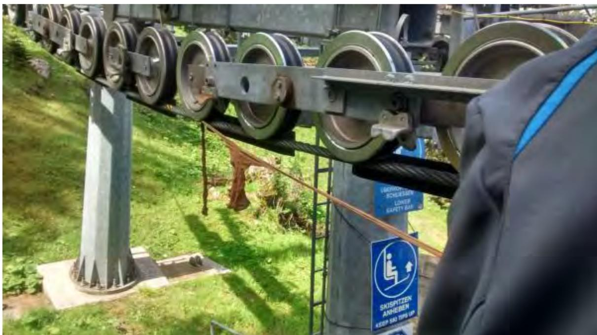
*Figura 4.16: Collant in nylon rimasto impigliato fra fune e rulli*
