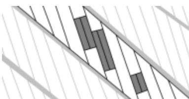
Figura 3.11: Ricostruzione grafica della rottura di fili multipli
