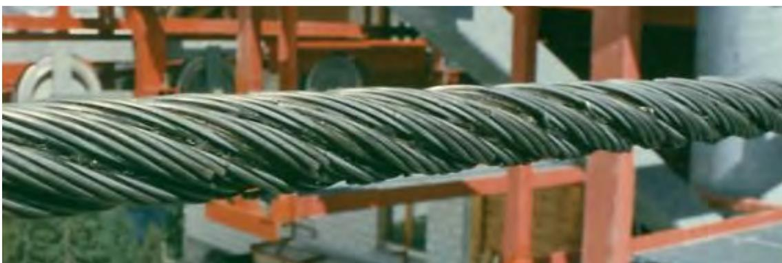
*Figura 2.1: Danni causati dallo scorrimento di un morsetto a due piastre scanalate e serraggio con bulloni*
