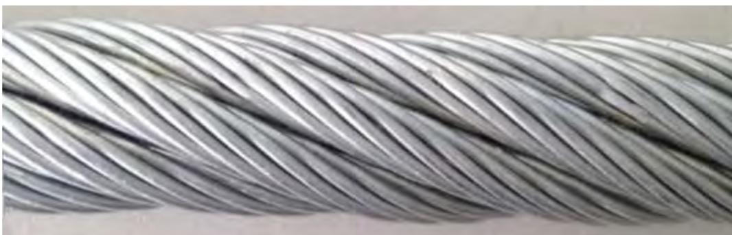
*Figura 5.15: fune in buono stato di pulizia*
