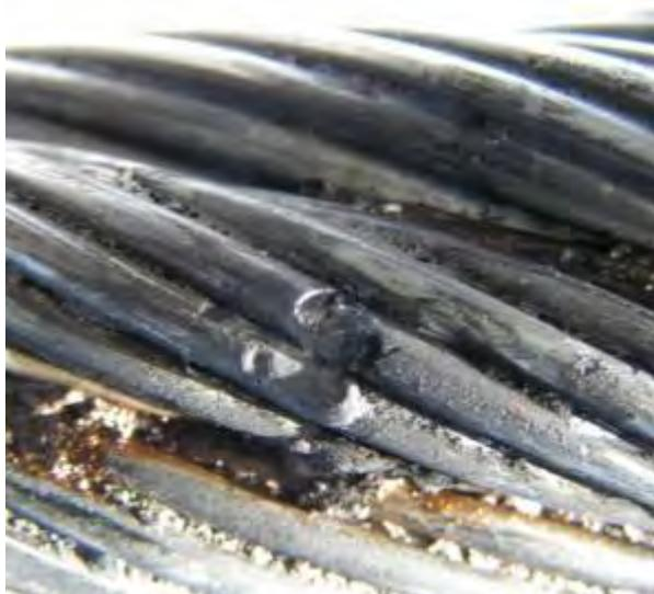
*Figura 2.4: Danno causato dal passaggio di corrente*
