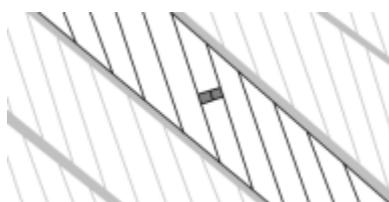
Figura 3.10: Ricostruzione grafica della rottura di un filo singolo
