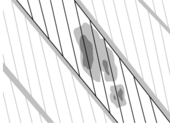
*Figura 3.3: Danno causato da un fulmine*
