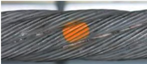
*Figura 3.23: Corrosione 1 x diametro trefolo*
