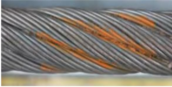
*Figura 3.21: Corrosione nell'avvallamento fra i trefoli*
