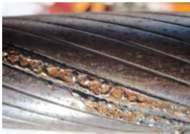
*Figura 2.11: Danno causato da un fulmine in una fune chiusa*
