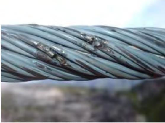
*Figura 3.2: Struttura martensitica con fili fusi*
