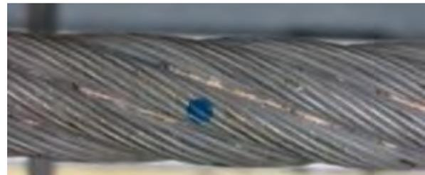
*Figura 3.7: Fulmine su trefolo del diametro di  $d \times 0,5$*
