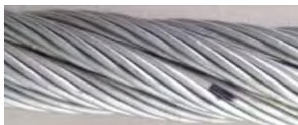
Figura 3.13: Rottura di un filo singolo del trefolo
