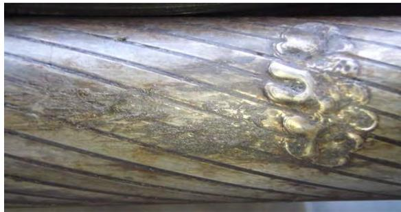
*Figura 2.14: Punto di impatto nella parte inferiore della fune*
