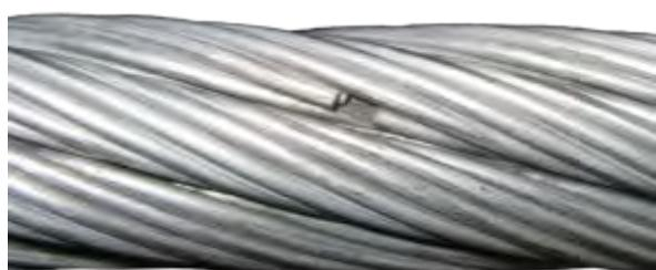
Figura 3.8: Rottura di un filo singolo
