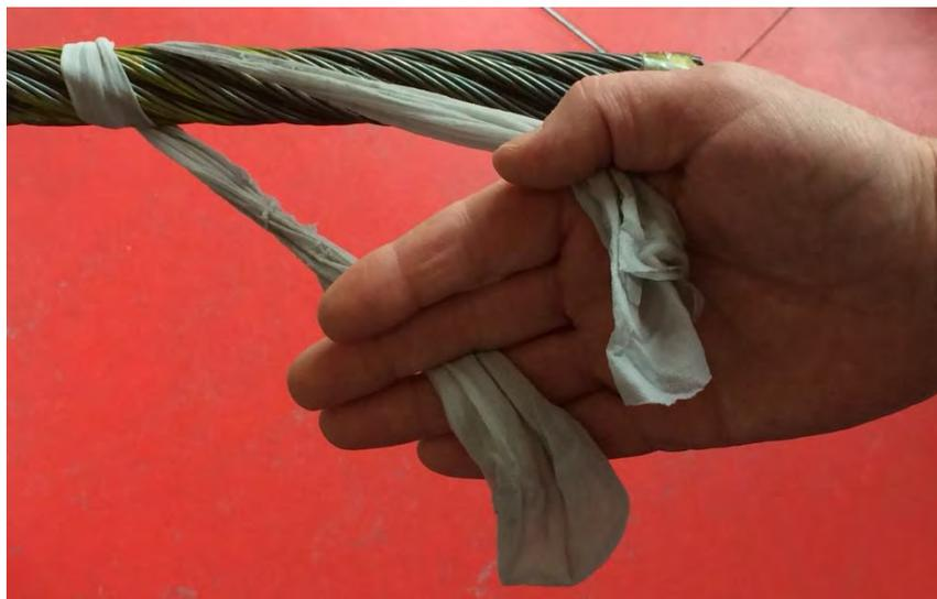
Figura 4.17: Posizione sicura per tenere la calza in nylon
