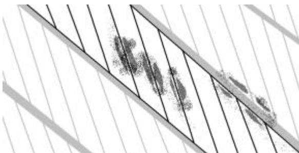
Figura 3.19: Corrosione nell'avvallamento tra i trefoli graficamente semplificata
