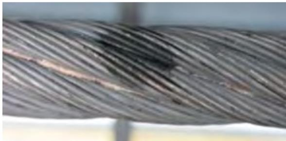
*Figura 3.4: Fulmine su trefolo del diametro di  $d \times 1,5$*
