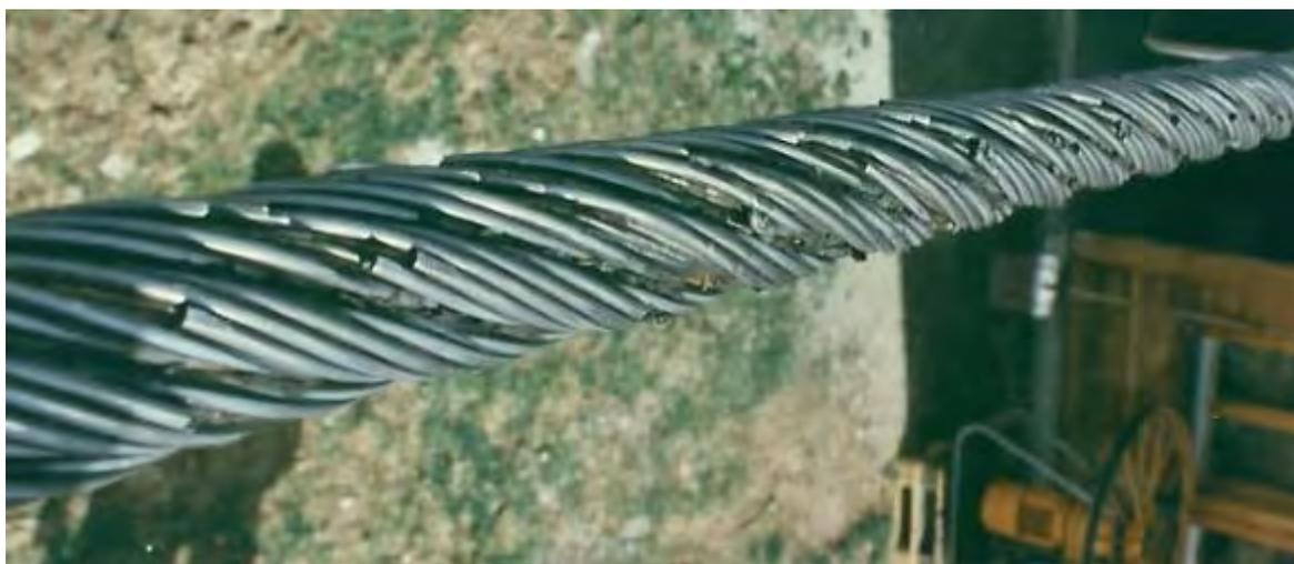
*Figura 2.2: Danni causati dallo scorrimento di un morsetto a due piastre scanalate e serraggio con bulloni*
