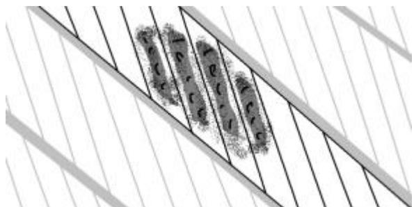
Figura 3.20: Corrosione di più trefoli graficamente semplificata
