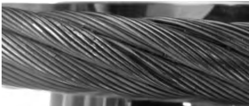
*Figura 4.22 Danno rilevato durante l'ispezione*
