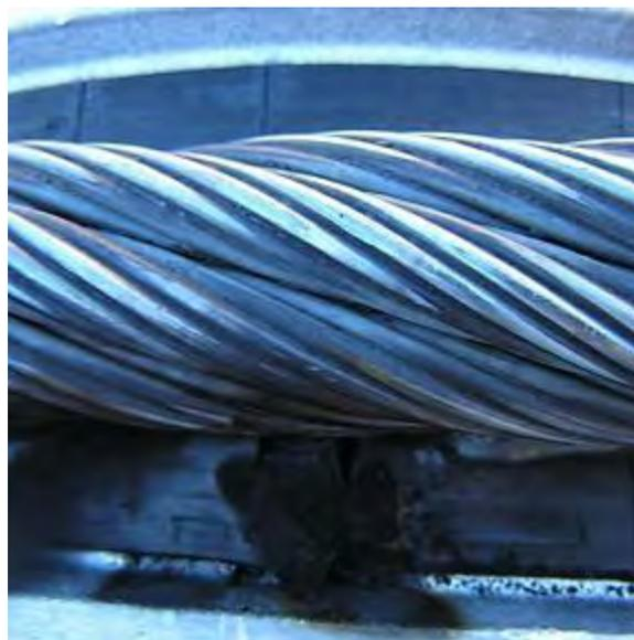
*Figura 2.5: Danno causato dal passaggio di corrente*
