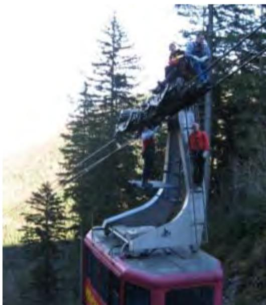
*Figura 0.8: Ispezione visiva della fune portante su scala, piattaforma, sedile e carrello*
