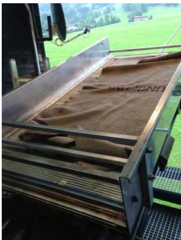
Figura 4.24: Piattaforma per esame visivo delle funi portanti presso la stazione di Grünten
