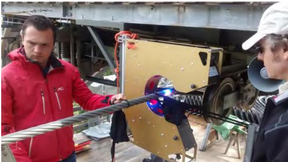
*Figura 4.15: Ispezione con collant in nylon*
