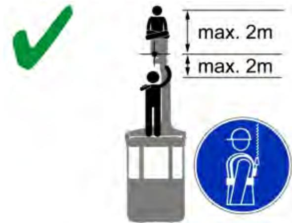
Figura 5.12: Buon posizionamento durante l'ispezione della fune portante
