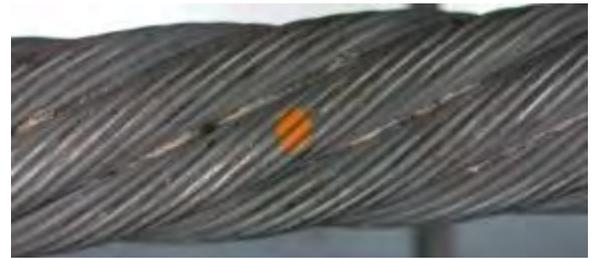
*Figura 3.24: Corrosione 0,5 x diametro trefolo*
