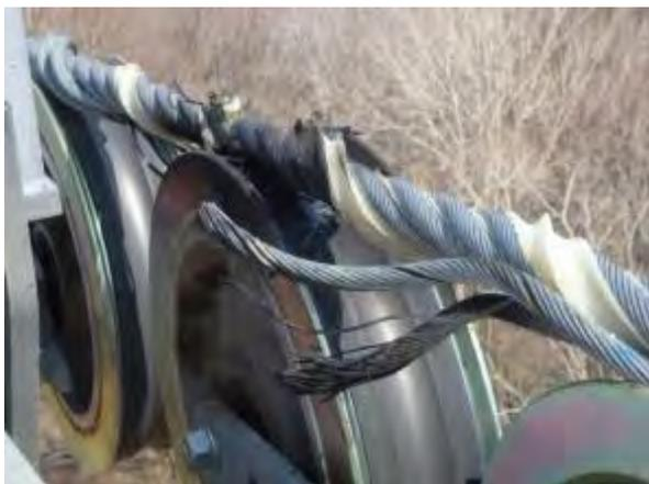
*Figura 2.6: Danno causato dal passaggio di corrente*
