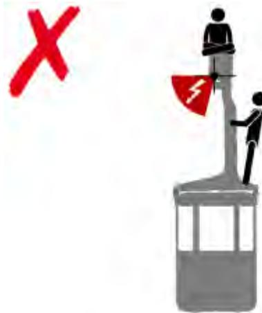
Figura 5.11: Posizionamento non idoneo durante l'ispezione della fune portante. Circa 45° di fune non risultano visibili.
