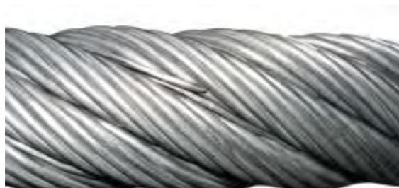
Figura 3.9: Rottura con filo sporgente
