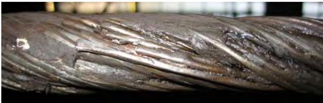
*Figura 5.13: Sporco lungo la fune – Impossibile effettuare l'esame visivo*
