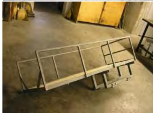
*Figura 0.5: Struttura per effettuare l'esame visivo delle funi*
