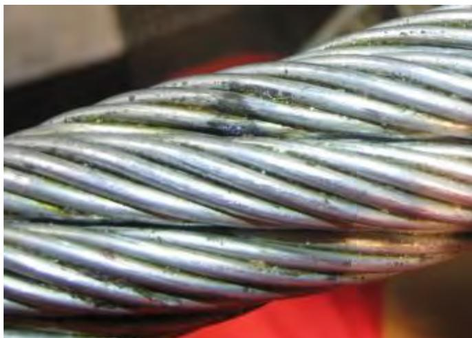
*Figura 3.1: Scolorimento causato dalla scarica di un fulmine*
