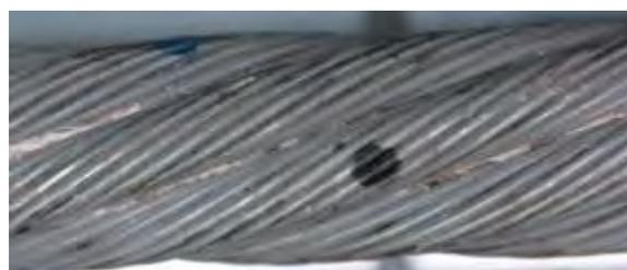
Figura 3.14: Rottura del filo  $0,5 \times$  diametro trefolo
