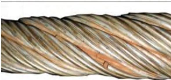
Figura 3.17: Corrosione dei trefoli (con frattura del filo)
