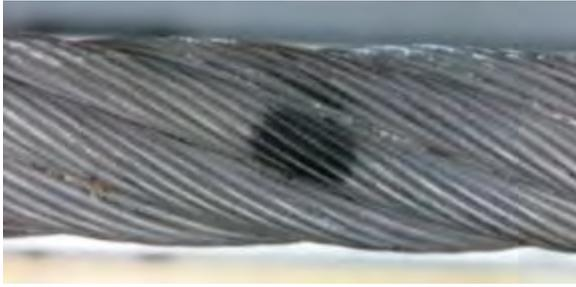
Figura 3.15: Rottura del filo 1 x diametro trefolo
