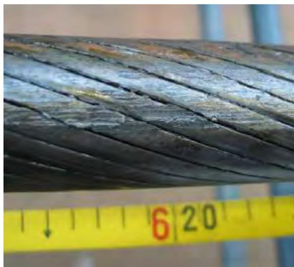
*Figura 2.9: Danno alla fune portante – Immagine di dettaglio [6]*
