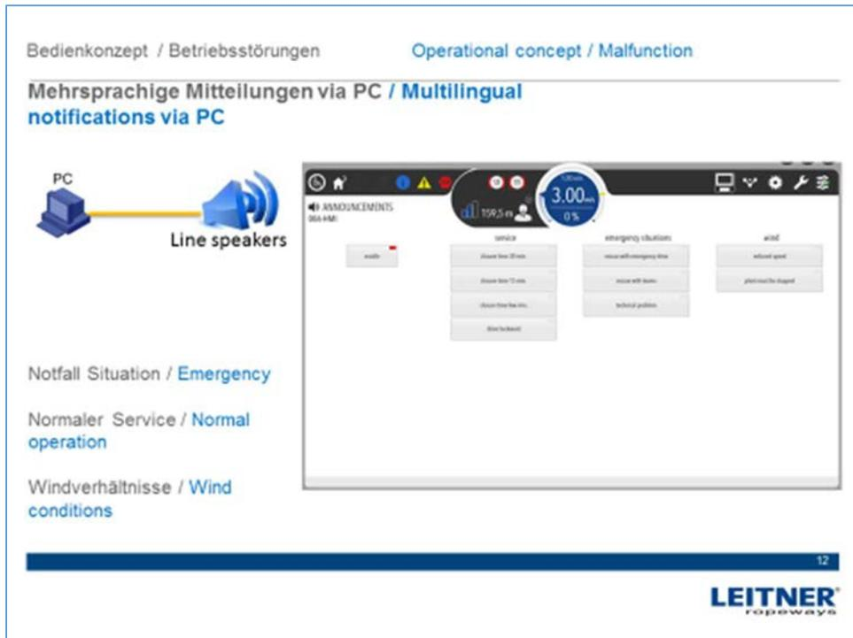
Für den Fall von Betriebsstörungen sind als Hilfestellung für den Maschinisten standardisierte Durchsagetexte gespeichert. Dadurch können die Durchsagen in mehreren Sprachen gut verständlich per Knopfdruck abgerufen werden.
