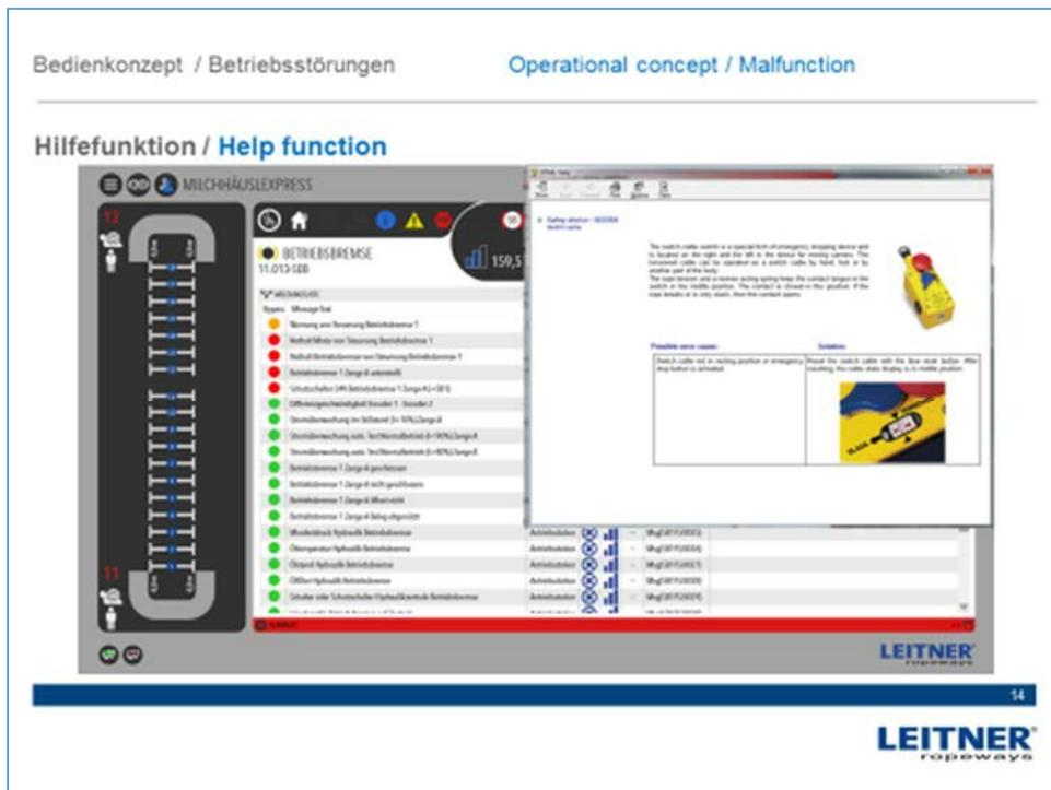
Für die Behebung von Störfällen oder wie hier bei als Hilfestellung für die Überbrückung von Sicherheitseinrichtungen besitzt das System eine integrierte Hilfefunktion mit einer Verlinkung zu Schaltplänen und Hilfetexten analog zum Handbuch.
