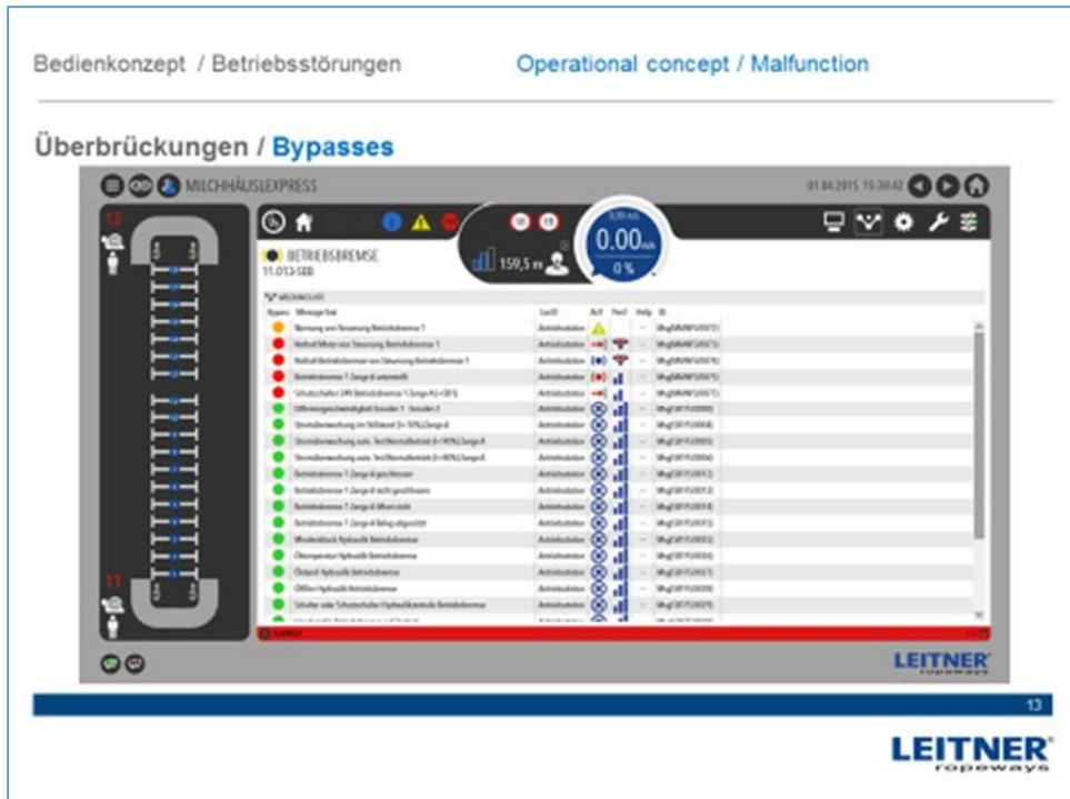
Das Bedienkonzept beinhaltet auch eine Oberfläche für die Überbrückung von Sicherheitseinrichtungen.
