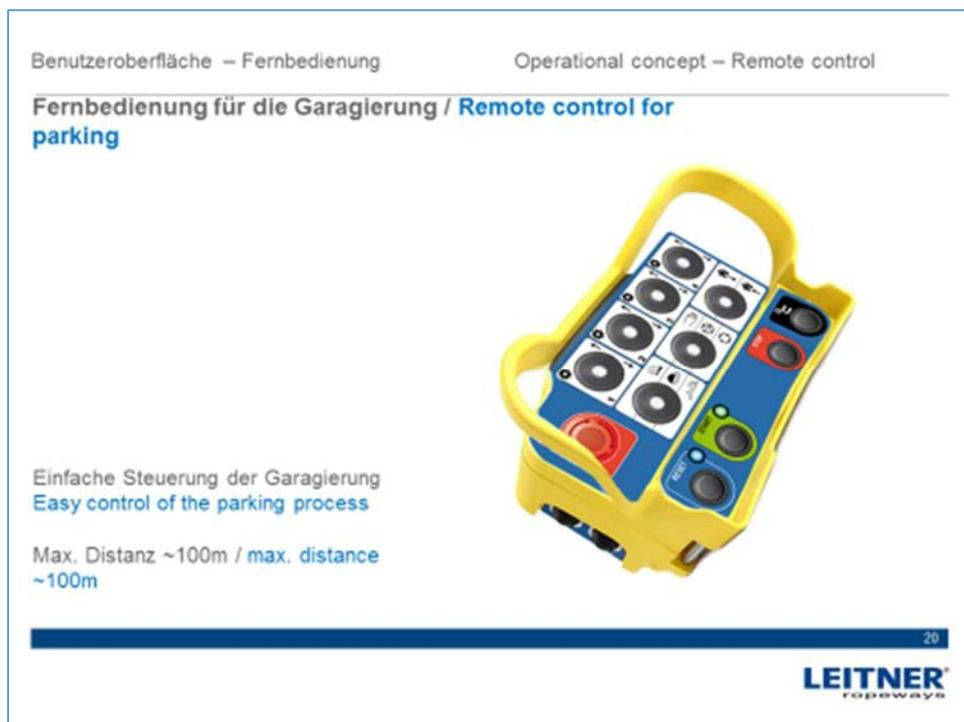
Eine zweite Fernbedienung erlaubt die Steuerung der Garagierung, so dass der Bedienstete keinen fest vorgegebenen Standplatz mehr einnehmen muss und auch kein Kabel hinter sich her ziehen muss.
