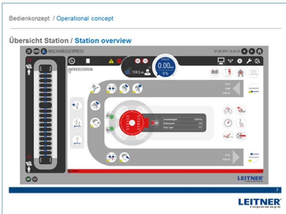
Durch Anklicken einer Station gelangt man in die nächste Ebene, die Stationsübersicht mit sämtlichen Funktionen und deren aktuellen Zustand. Durch Anklicken der Funktion wird wiederum in die nächste Ebene, die Funktionsebene gesprungen.
