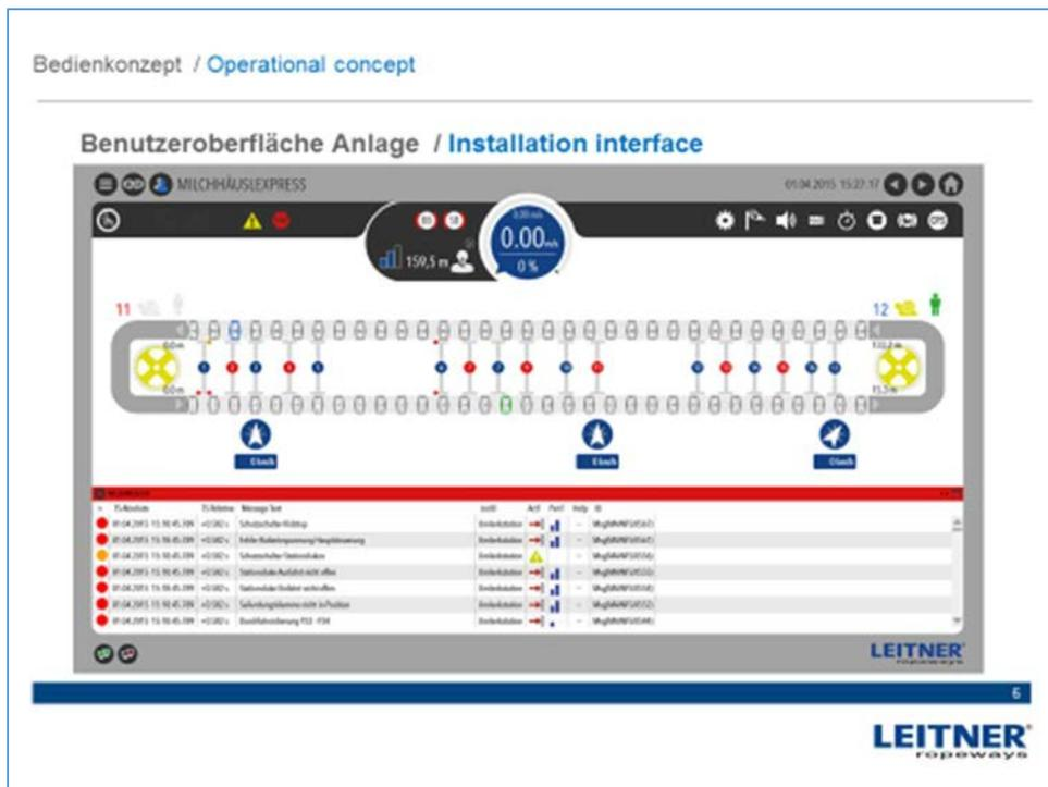
In der ersten Ebene sieht der Maschinist die für ihn wichtigen Daten wie Fahrgeschwindigkeit und Windgeschwindigkeit mit Windrichtung an den jeweiligen Stützen. Ebenso werden eventuell anstehende Meldungen angezeigt.
