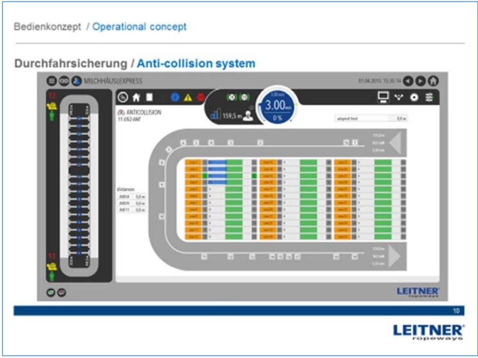
Als nächstes Beispiel die Durchfahrtsicherung der Station. Auch hier werden die Lage der Näherungsschalter, der Schaltzustand und die Handbuchhinweise angezeigt.
