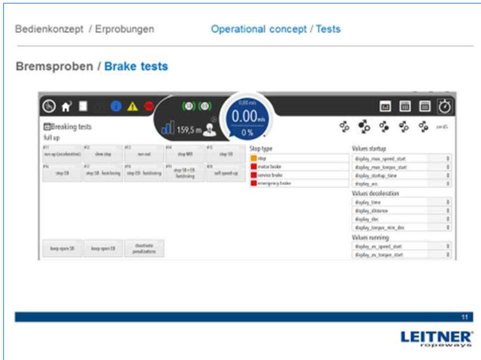
Auch alle Funktionen für die Erprobung der Anlage werden über das Bedienpult und den Bildschirm gesteuert.
