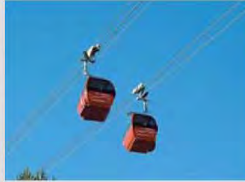
Kuppelbare Zweiseil-Umlaufbahn (BGD) La Massana, Andorra (AD)
