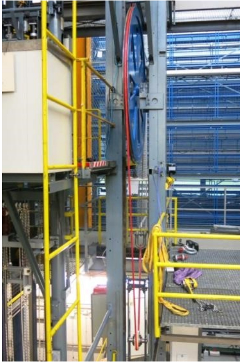
Abbildung 7: Dauerbiegeversuch mit rotgecoatetem Prüfling
