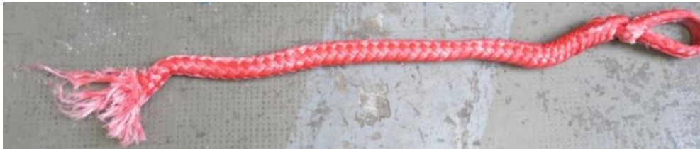
Abbildung 10: Bruchende des zuvor bis 300 Biegewechsel gefahrenen Musters
