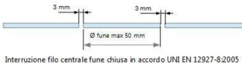
Figura 12: difetto standard secondo UNI 12927-8
