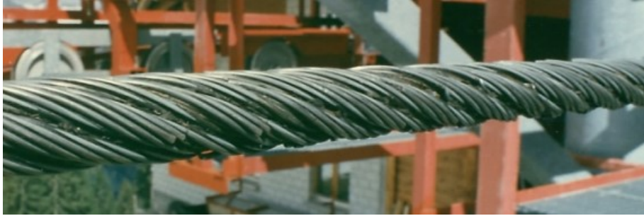
Abbildung 1: Folgeschäden von gerutschter Klemmplatte
