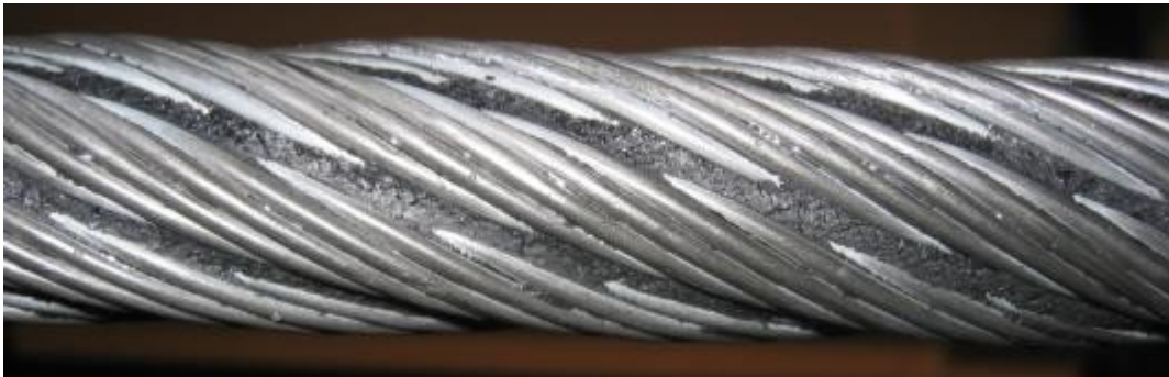
Abbildung 12: Schmutz in Litzengassen – schwer zu inspizieren
