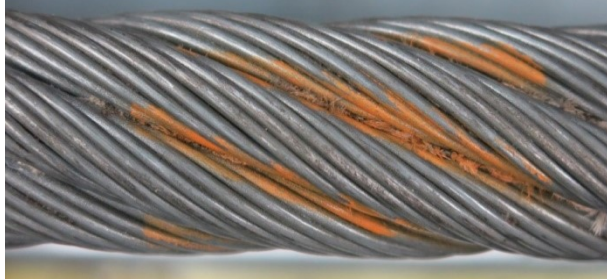
Abbildung 12: Künstliche Nachbildung Korrosion
