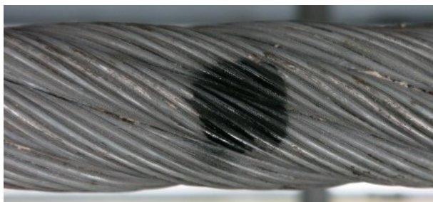
Abbildung 14: Künstliche Nachbildung Drahtbruchhäufung
