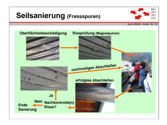
Nun, welche Methoden wurden zur Sanierung von Fressstellen angewendet:
