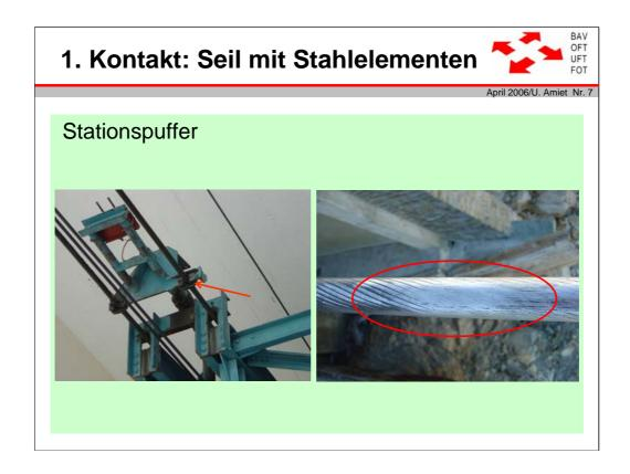
Kategorie 1: Schäden ausgehend durch den Seilkontakt mit Stahlteilen
