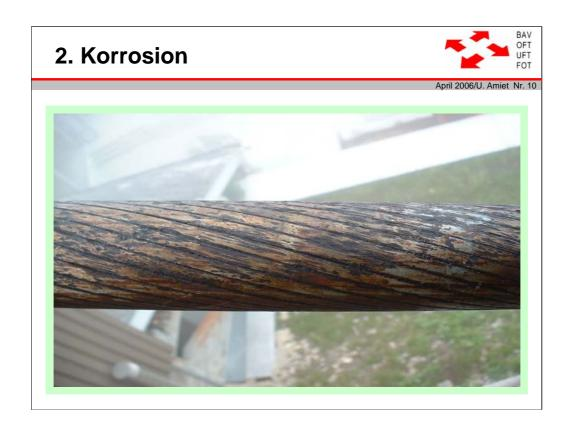
Hier sehen sie ein Beispiel von starker äusserer Korrosion, mit z.T mit ausgeprägten Korrosionsnarben
