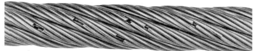
Gleichschlagseil mit Drahtbrüchen
