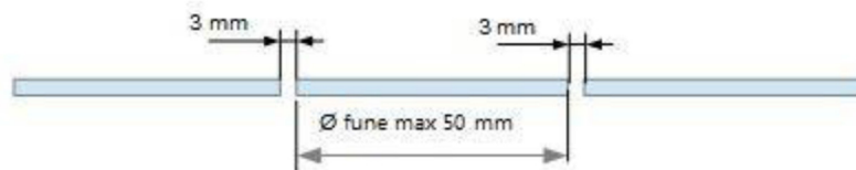
Interruzione filo centrale fune chiusa in accordo UNI EN 12927-8:2005
