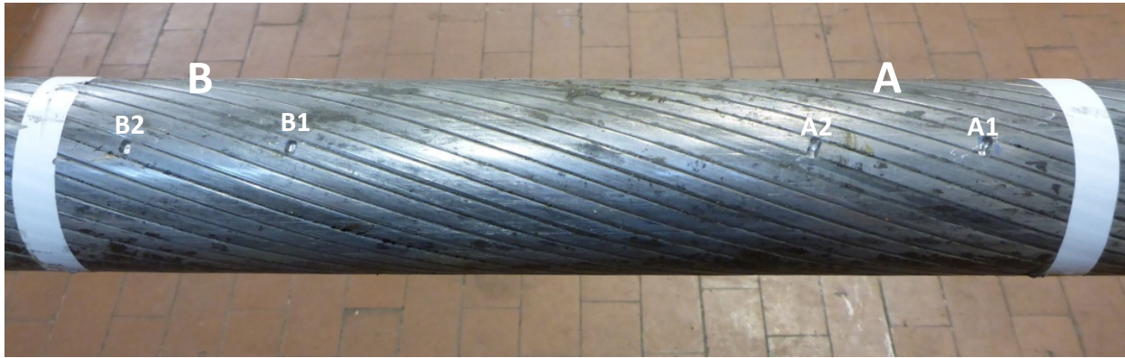
Figura 13: fune realizzata presso Laboratorio 2, difetti esterni
