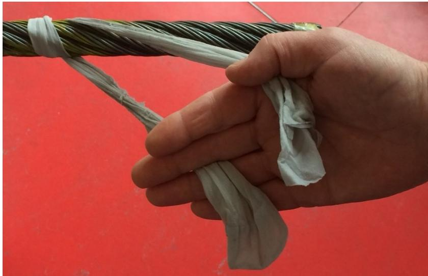
*Abbildung 19: Sicheres Halten eines Nylonstrumpfes*
