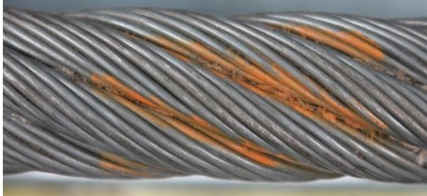
Abbildung 12: Künstliche Nachbildung Korrosion
