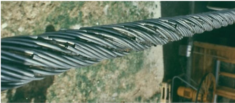
*Abbildung 2: Folgeschäden von gerutschter Klemmplatte*
