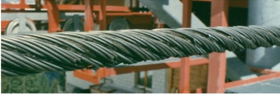
*Abbildung 1: Folgeschäden von gerutschter Klemmplatte*
